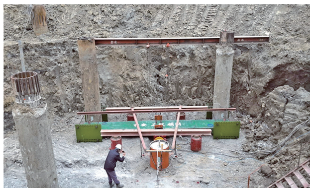
圖 21 側向反覆 (500 次) 加載試驗 (2015, 台安技術提供)
