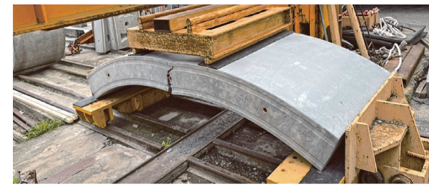
圖 11 預鑄鋼纖維混凝土環片抗彎試驗
