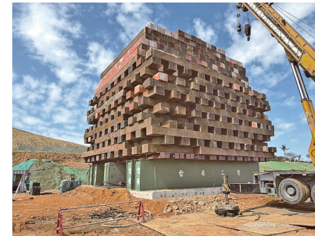
圖 16 呆重試樁及礫石層變形模數試驗（2025，台安技術提供）
